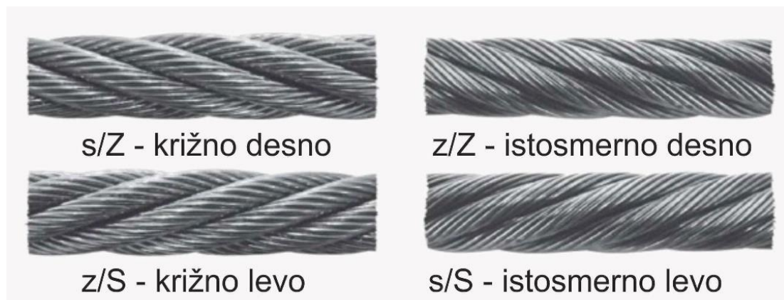
Slika 3: Križni in istosmerni korak vrvi
